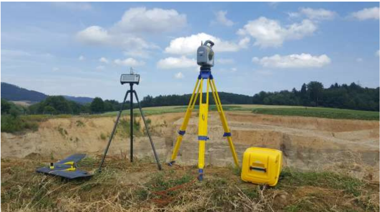
Figura 2: el VANT eBee Plus de senseFly (izquierda) junto al controlador manual SX10 de Trimble (centro) y la estación total de escaneo SX10 con maletín de transporte (derecha).
