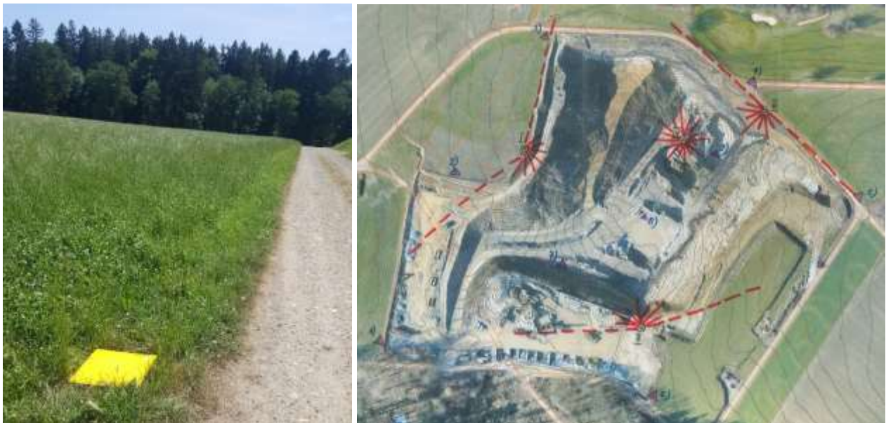
Figura 3: Uno de los nueve puntos de control terrestre del proyecto (izquierda) y un boceto preliminar en el que se muestran las posibles estaciones de escaneo (derecha).
