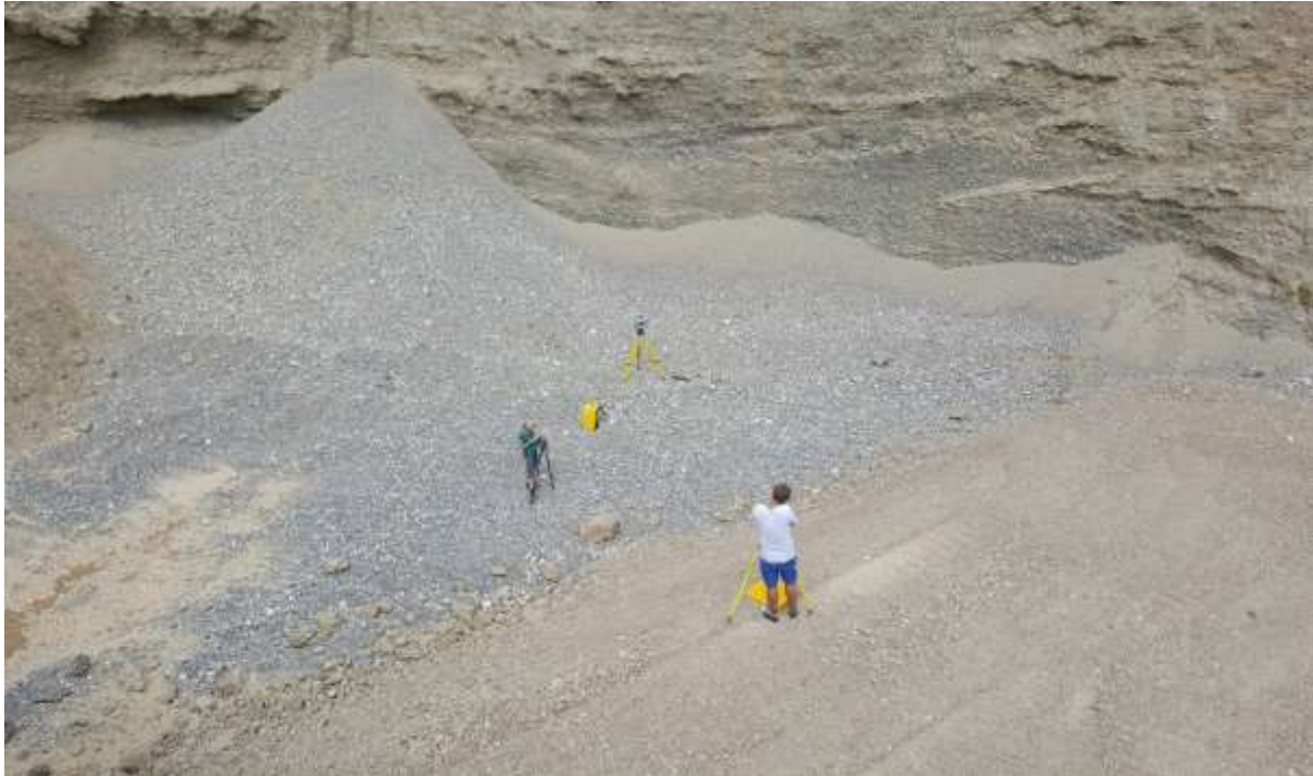
Figura 5: Proceso de orientación de la estación total de escaneo Trimble SX10 en el fondo de la gravera.
